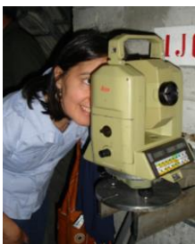
Figura 8 – Barragem do Alto Lindoso – poligonal de precisão – taqueómetro eletrônico (Leica TC 2003)
