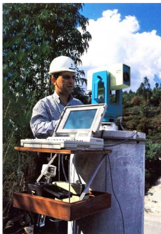
Figura 2 – Barragem de Crestuma – Observação da Rede de Triangulação com recurso ao Kern Mekometer ME 5000
