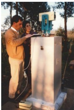
Figura 10 – GEObase de Estremoz (IPCC) – Calibração do ME 5000
