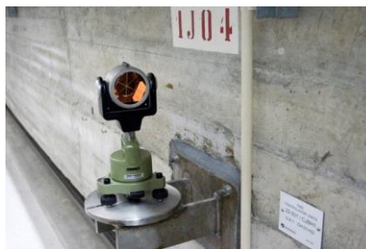
Figura 9 – Barragem do Alto Lindoso – poligonal de precisão – prisma refletor (Leica GPH1P) para TC 2003
