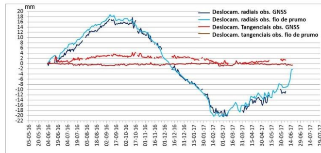
Figura 11 – A comparação entre os deslocamentos observados pelo fio de prumo e os deslocamentos observados pelo GNSS, nas componentes horizontais, na estação da consola central da barragem de Foz Tua. A linha vermelha representa as médias móveis dos deslocamentos observados pelo GNSS (soluções horárias) no sentido tangencial; a linha azul escura representa as médias móveis dos deslocamentos observados pelo GNSS (soluções horárias) no radial; a linha castanha representa os deslocamentos observados pelo fio de prumo, no sentido tangencial; a linha azul clara representa os deslocamentos observados pelo fio de prumo, no sentido radial
