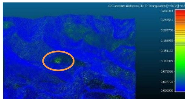
Figura 9 – Zoom das diferenças calculadas entre as nuvens de pontos LST e VANT
