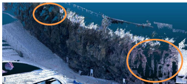
Figura 4 – Vista Geral do Talude e identificação de zonas de sombra
