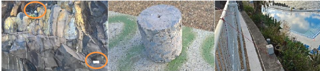
Figura 3 – Blocos artificiais utilizados para a simulação da queda de volume rochoso
