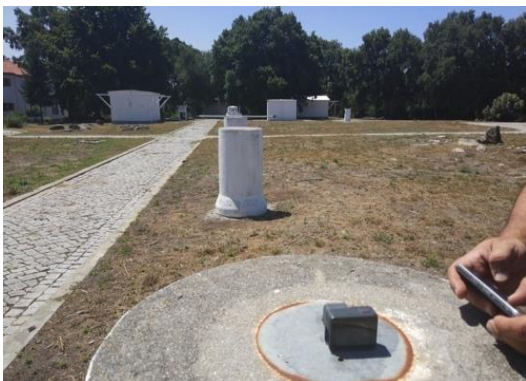
Figura 2 – Câmara e estadia de invar montadas sobre os pilares
