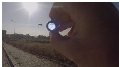
Figura 7 – Utilização da lanterna LED para registar um evento de sincronização no vídeo
