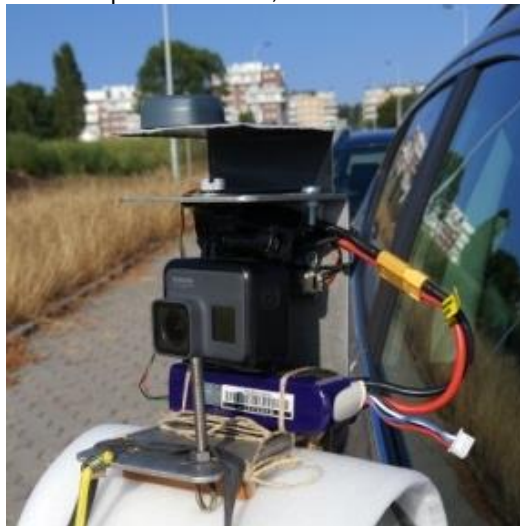
Figura 1 – Solução desenvolvida montada sobre um retrovisor
